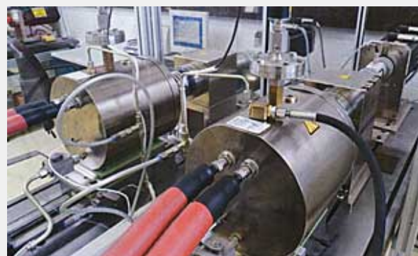
Langzeit-Verschleißprüfstand von Wellendichtringen
